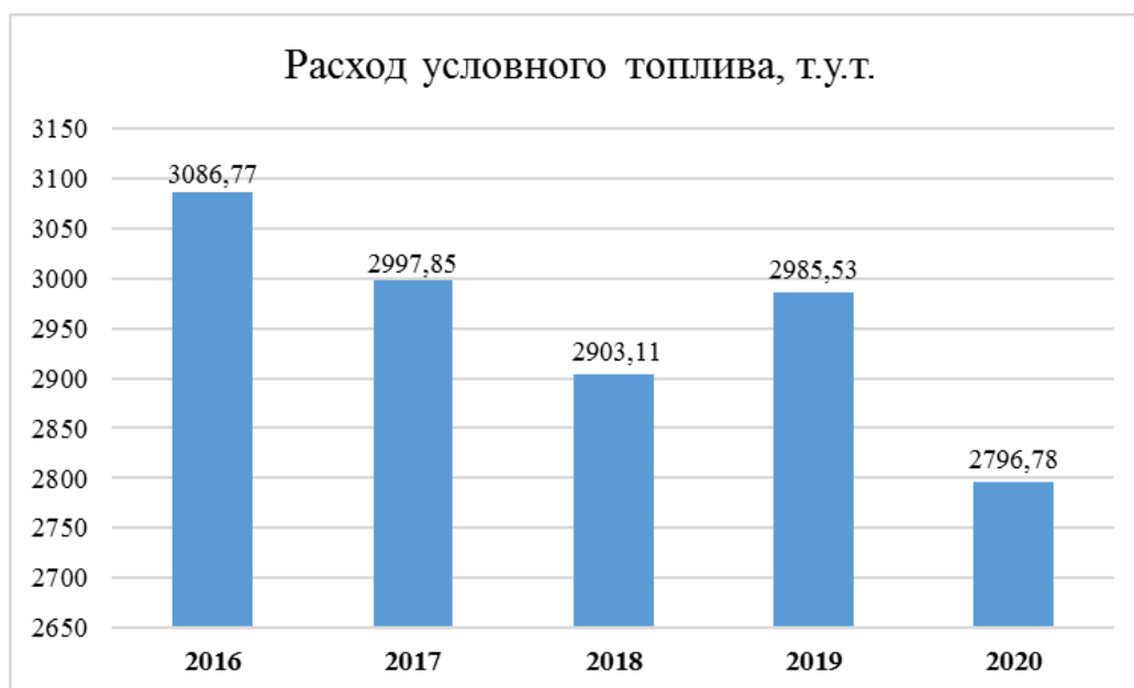
Рисунок 63 – Расход условного топлива на котельной «Абрам-Мыс»
