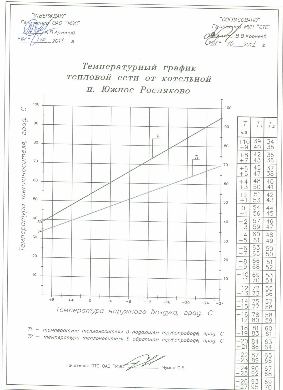
Рисунок 37 - Температурный график тепловой сети котельной ТЦ «Росляково Южное»
