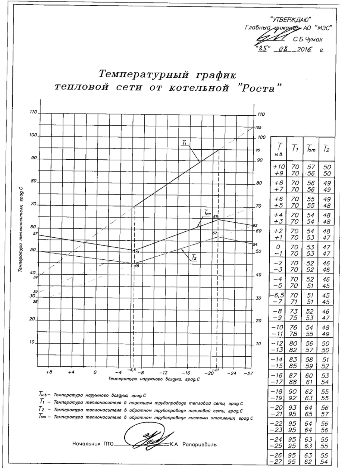
Рисунок 34 – Температурный график тепловой сети котельной «Роста»
