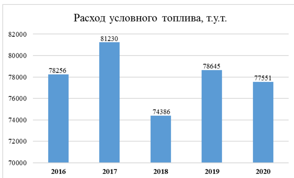
Рисунок 58 – Расход условного топлива на Восточной котельной
