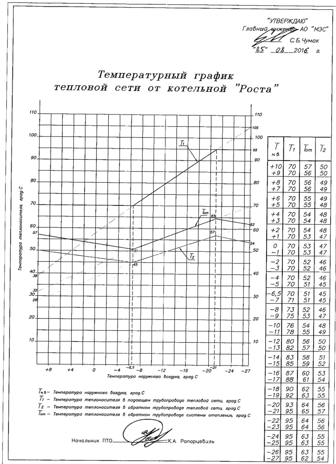
Рисунок 35 – Температурный график тепловой сети котельной «Роста»
