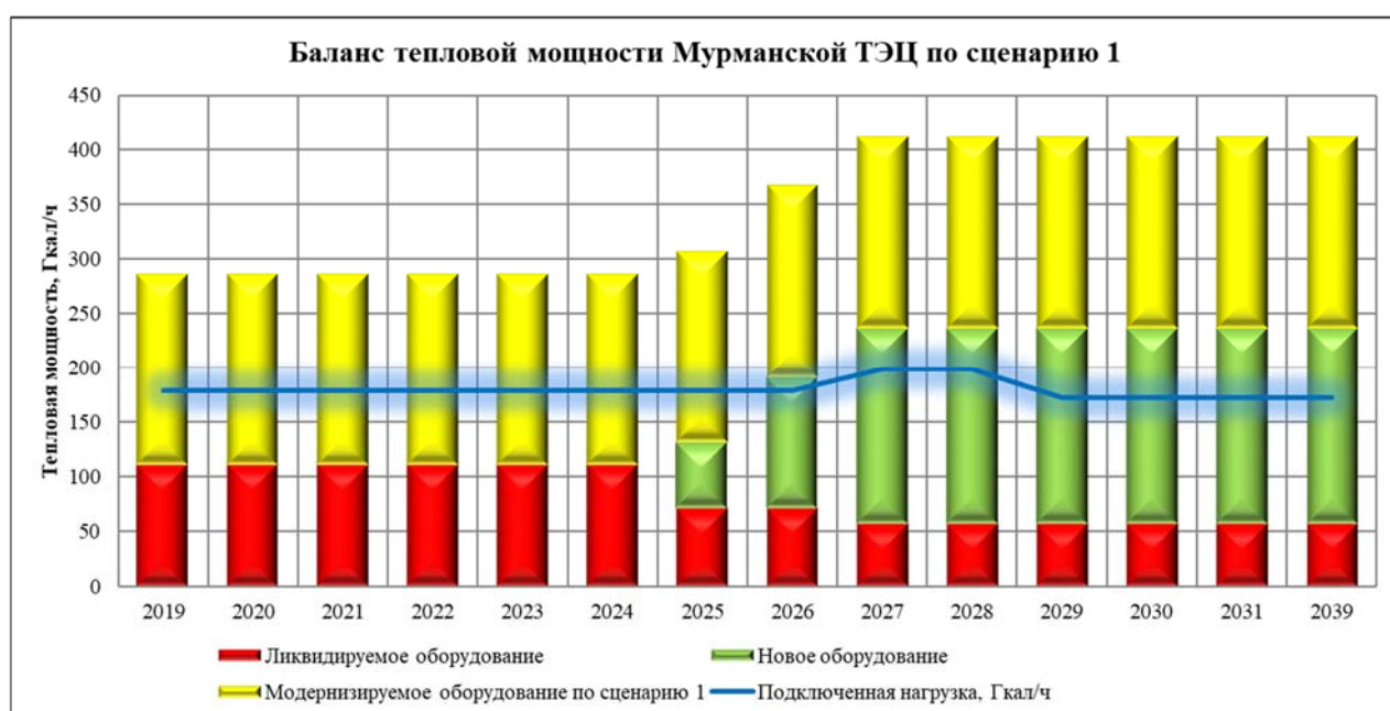
Рисунок 2. Баланс тепловой мощности Мурманской ТЭЦ на период разработки схемы теплоснабжения по сценарию 1
