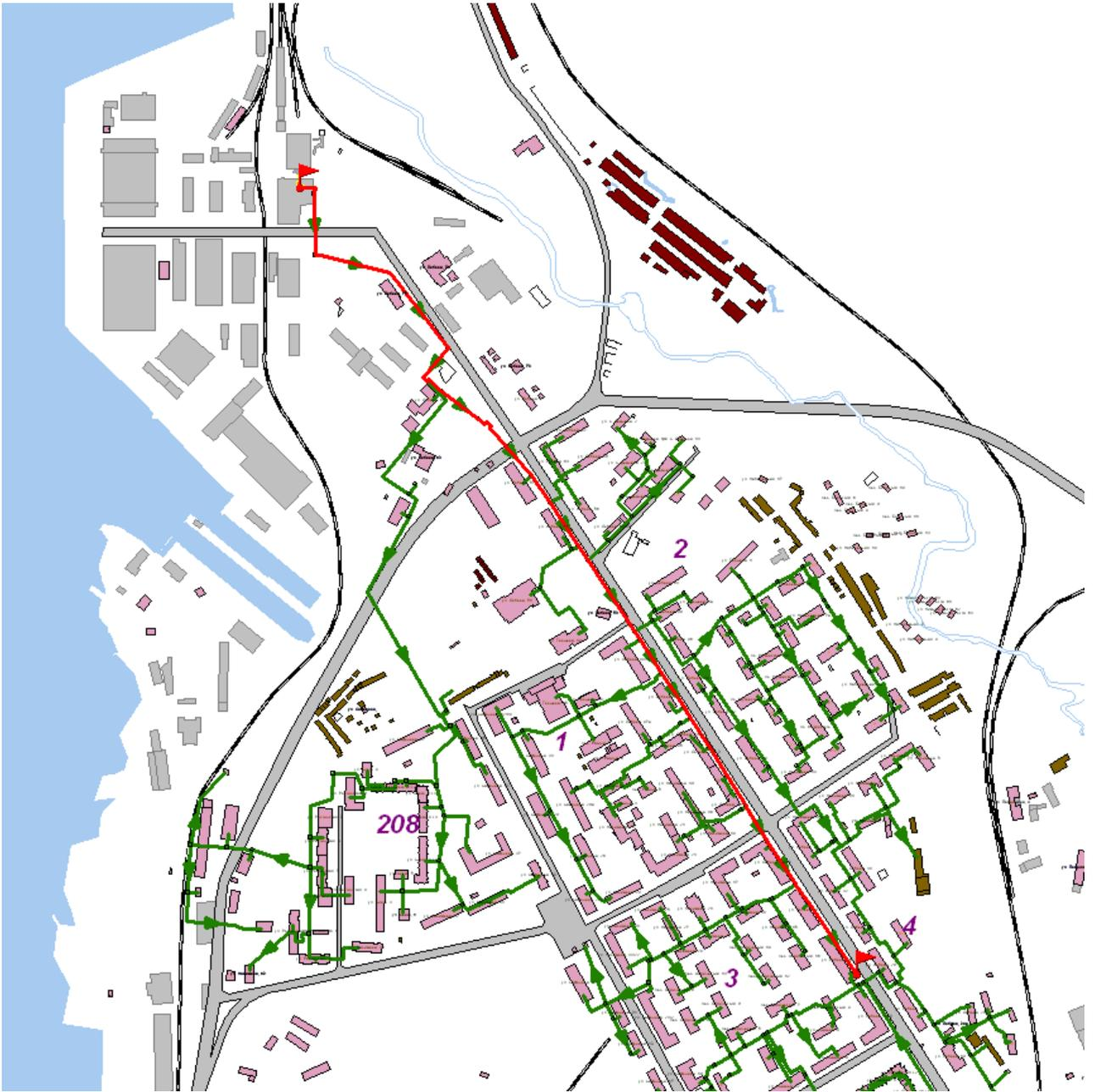
**Рисунок 8 – Схема прокладки магистрального вывода потребителям котельной РОСТА**
