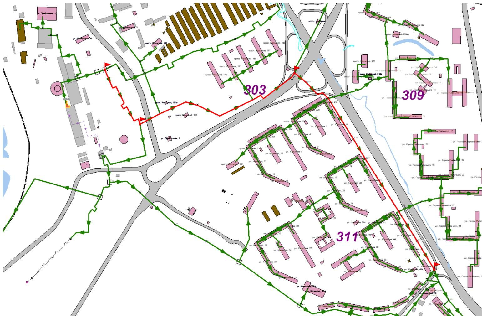
**Рисунок 4 – Схема прокладки тепломагистрали 2Луч 2» Южной котельной**
