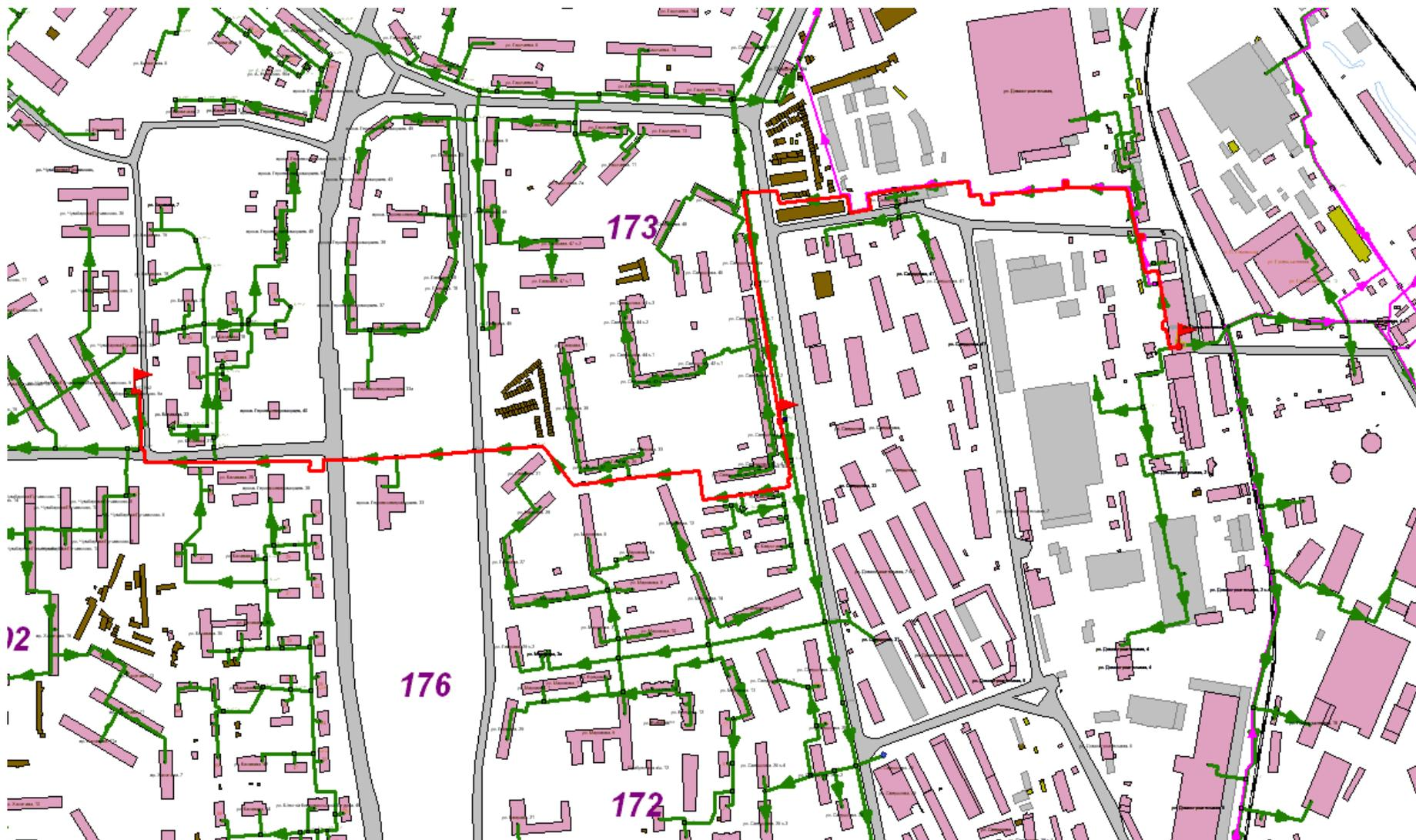
Рисунок 7 – Схема прокладки магистрального теплового вывода потребителям котельной «Северная»
