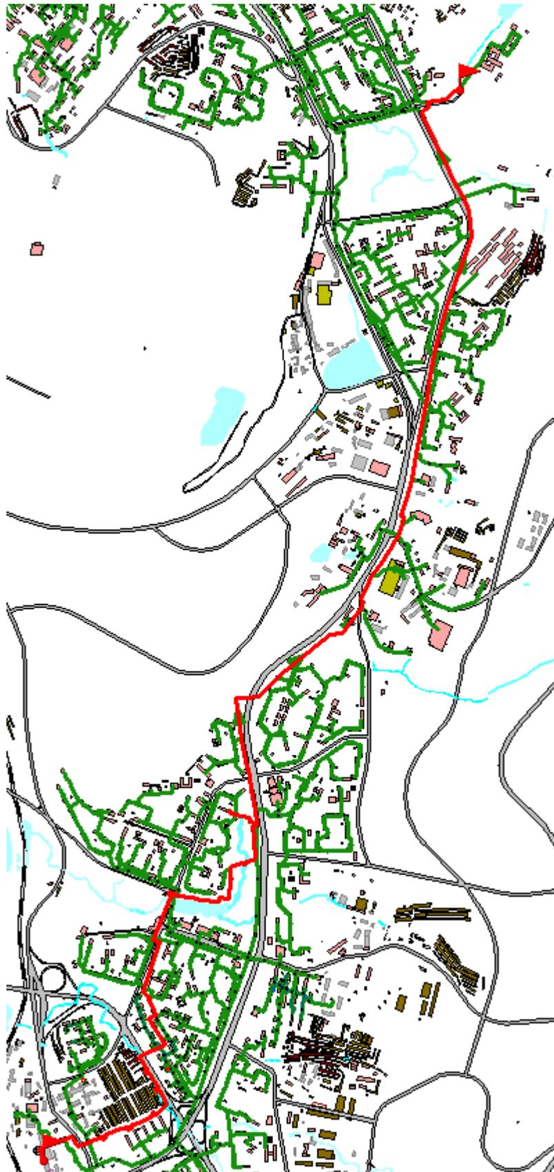
Рисунок 1.23. Путь построения пьезометрического графика Южная котельная – НС №9
