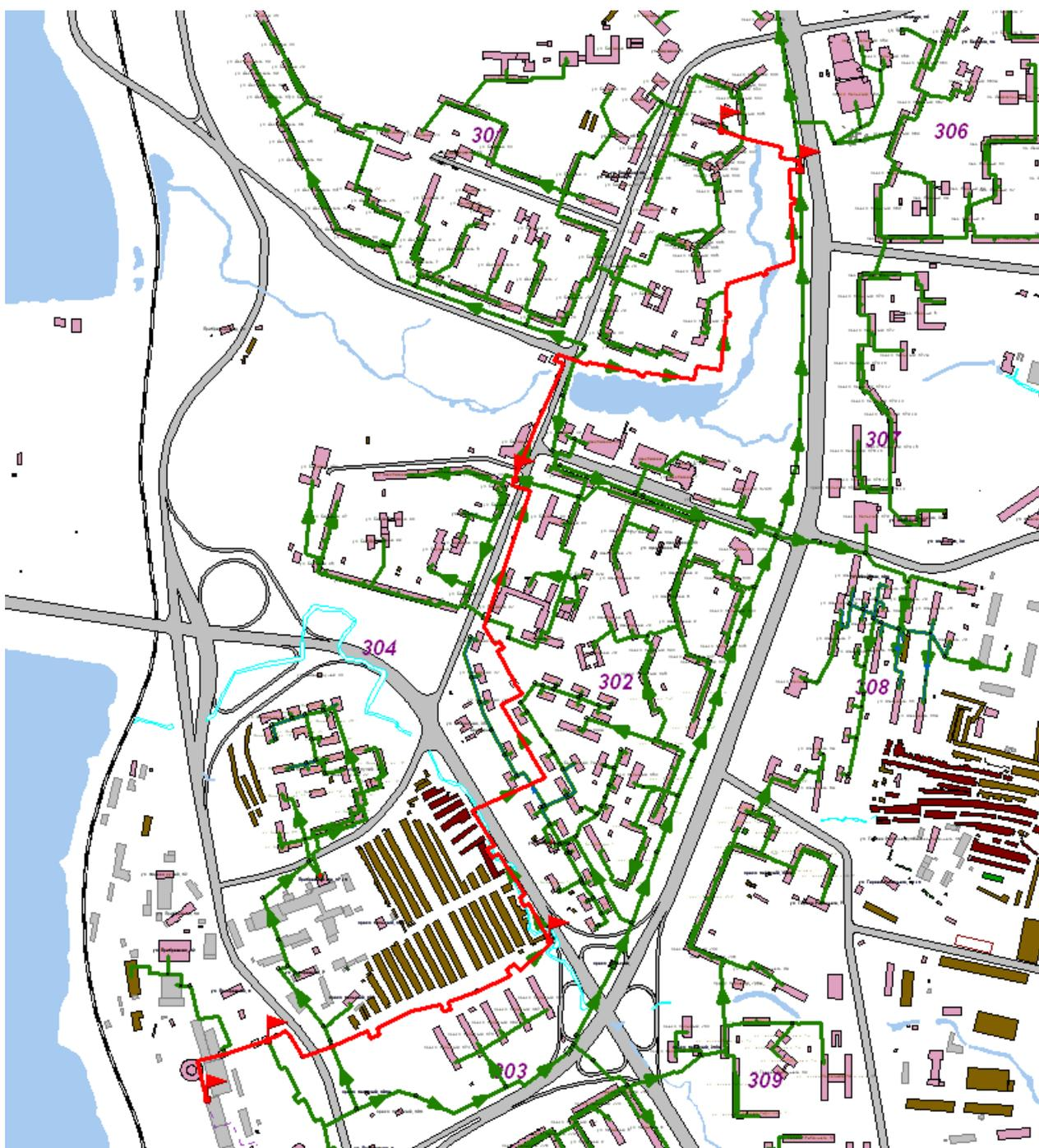
**Рисунок 3 – Схема прокладки тепломагистрالی «Луч 1» Южной котельной**
