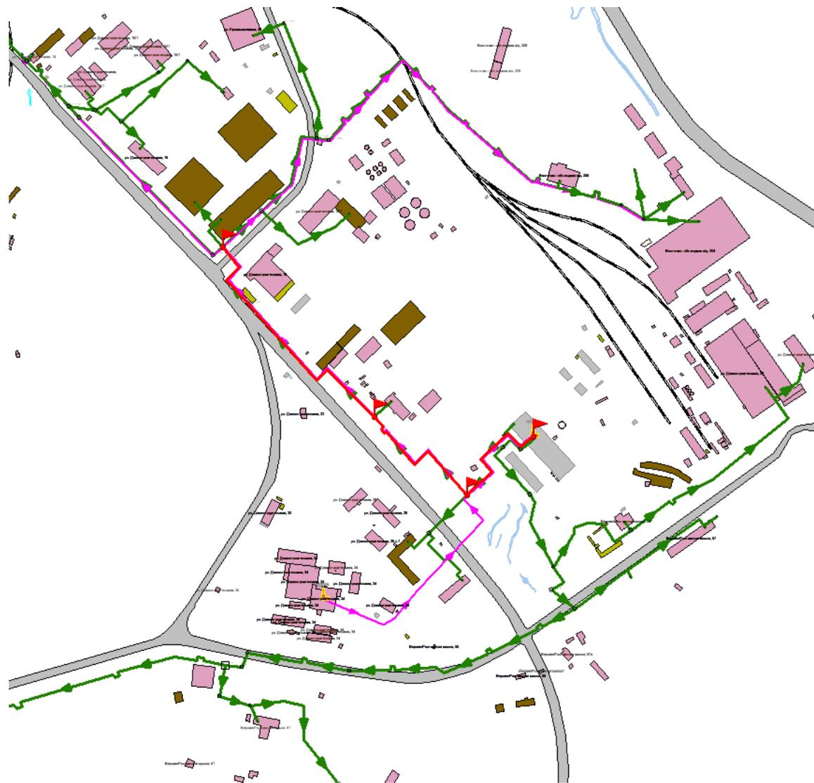
**Рисунок 6 – Схема прокладки тепломагистрالی «Луч 2» Восточной котельной**
