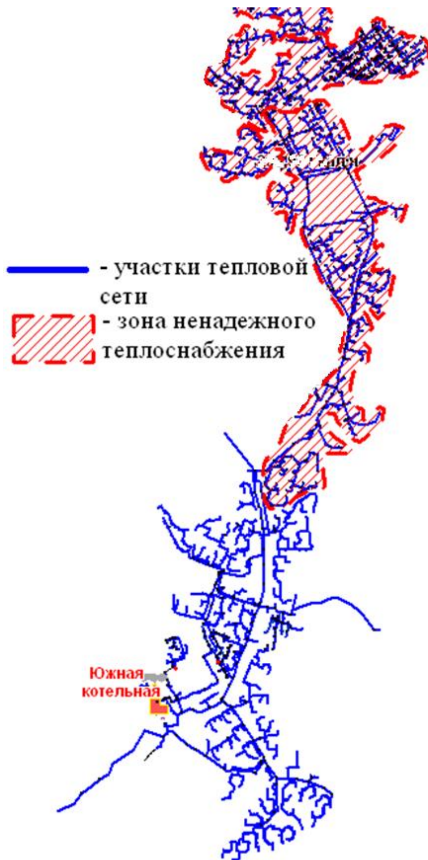
Рисунок 9.9 - Зона ненадежного теплоснабжения потребителей от Южной котельной
