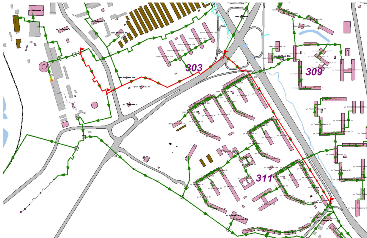
Рисунок 4 – Схема прокладки тепломагистрали 2Луч 2» Южной котельной
