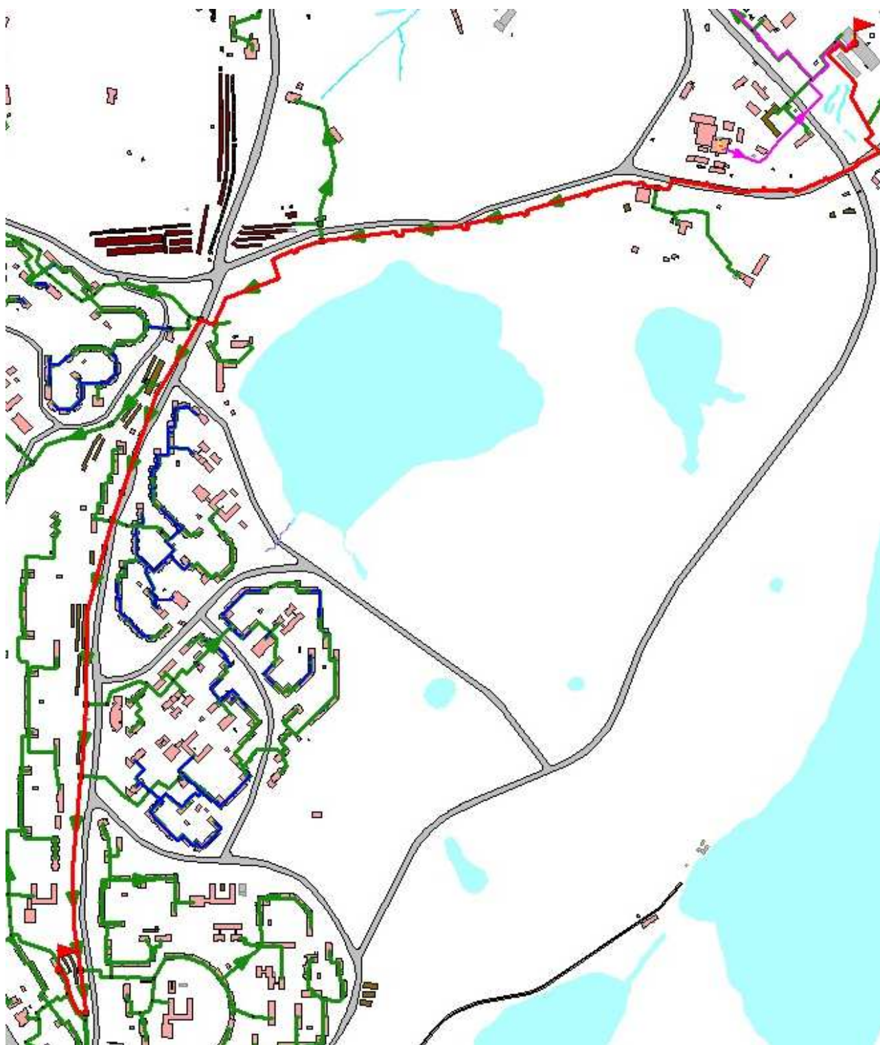
Рисунок 1.34. Путь построения пьезометрического графика Восточная котельная – НС №7
