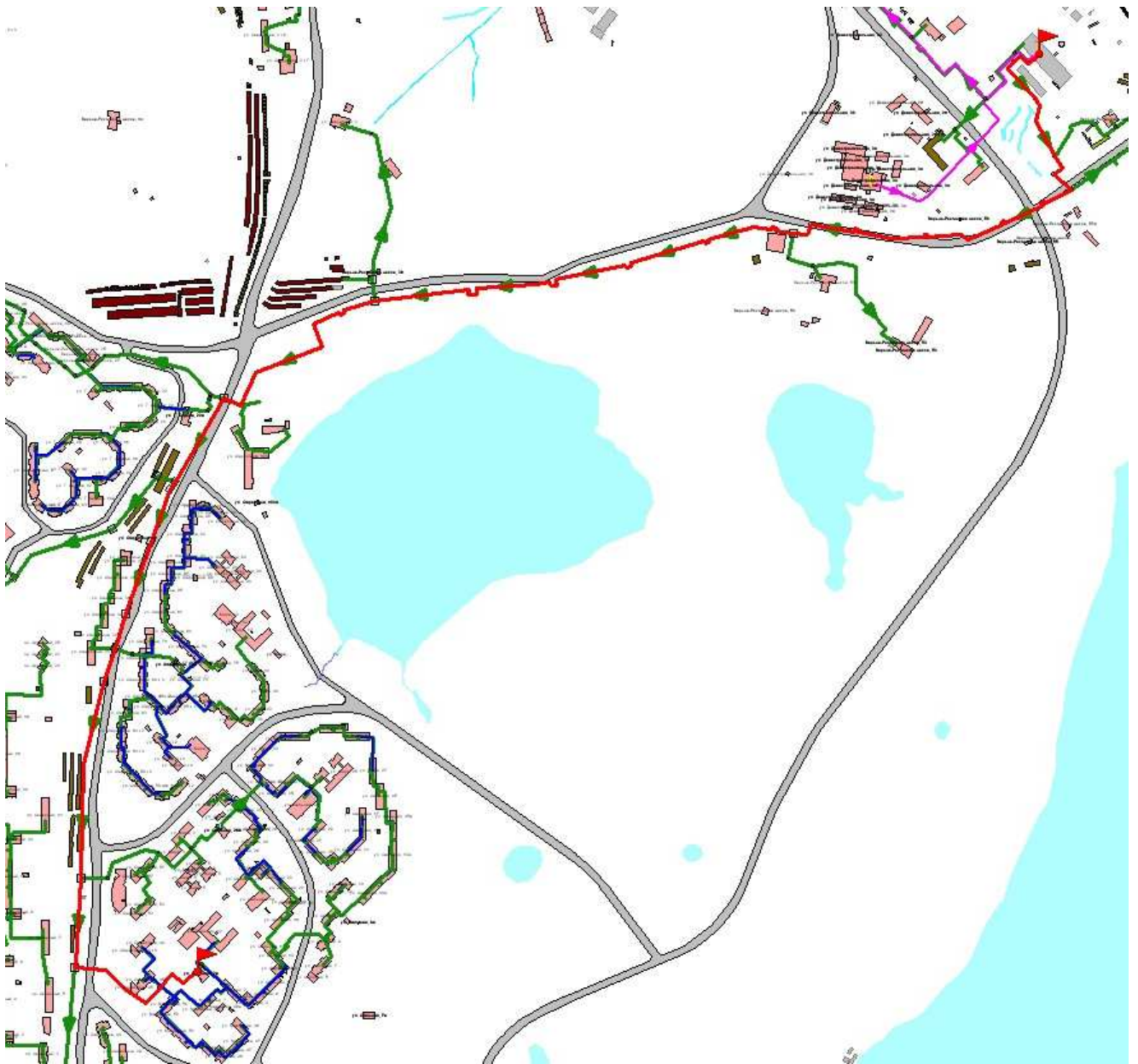
Рисунок 1.37. Путь построения пьезометрического графика Восточная котельная –ЦТП №1
