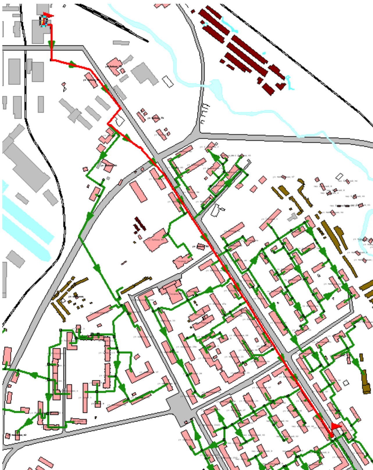
Рисунок 1.52. Путь построения пьезометрического графика котельная «Роста» - ТК-105
