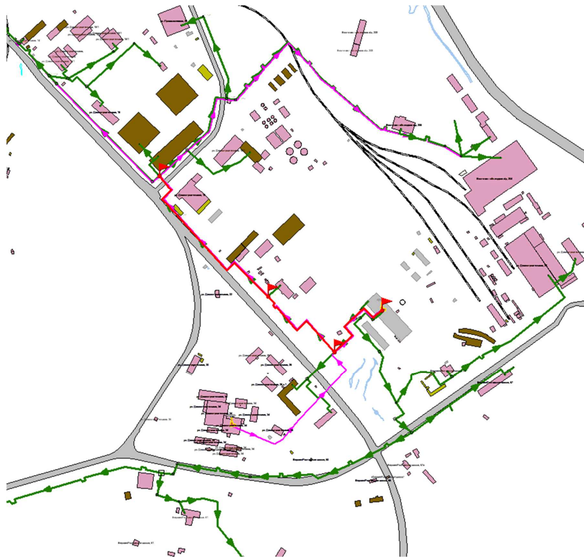
Рисунок 6 – Схема прокладки тепломагистрالی «Луч 2» Восточной котельной
