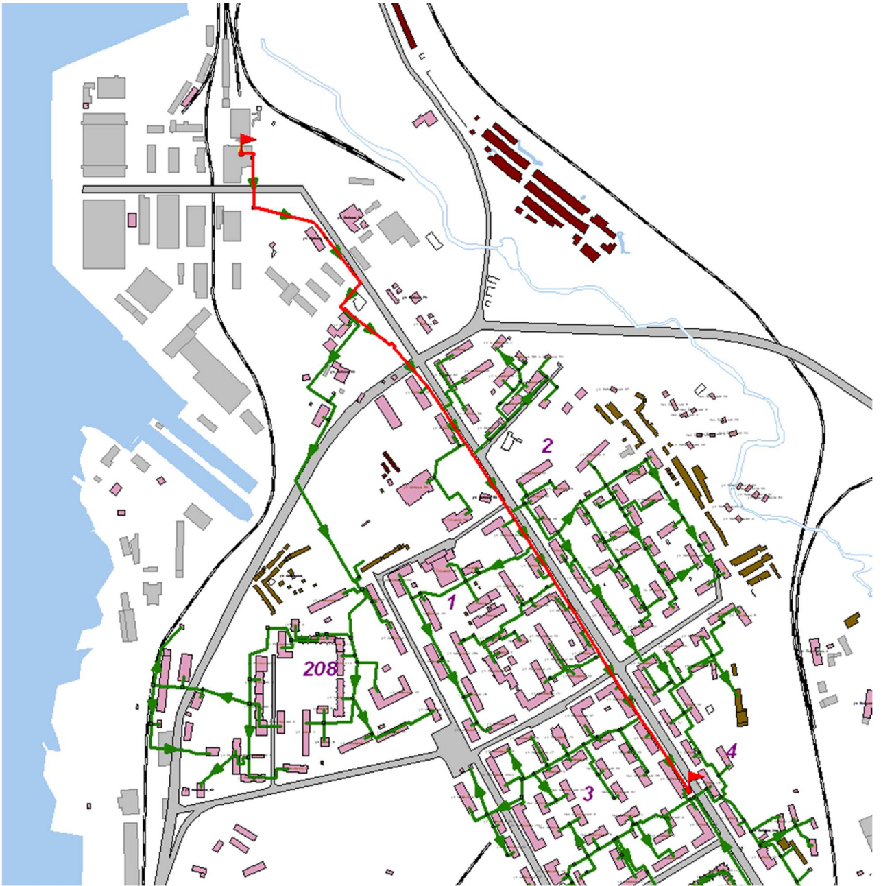
Рисунок 8 – Схема прокладки магистрального вывода потребителям котельной РОСТА
