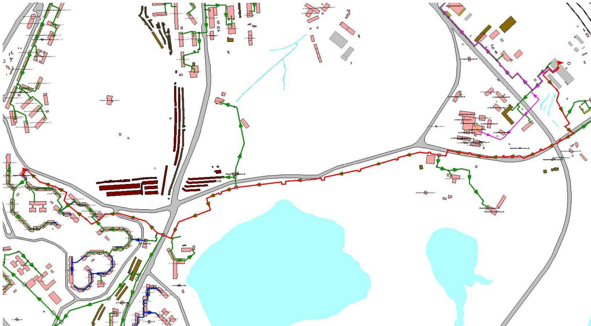
Рисунок 1.40. Путь построения пьезометрического графика Восточная котельная –ЦТП №5
