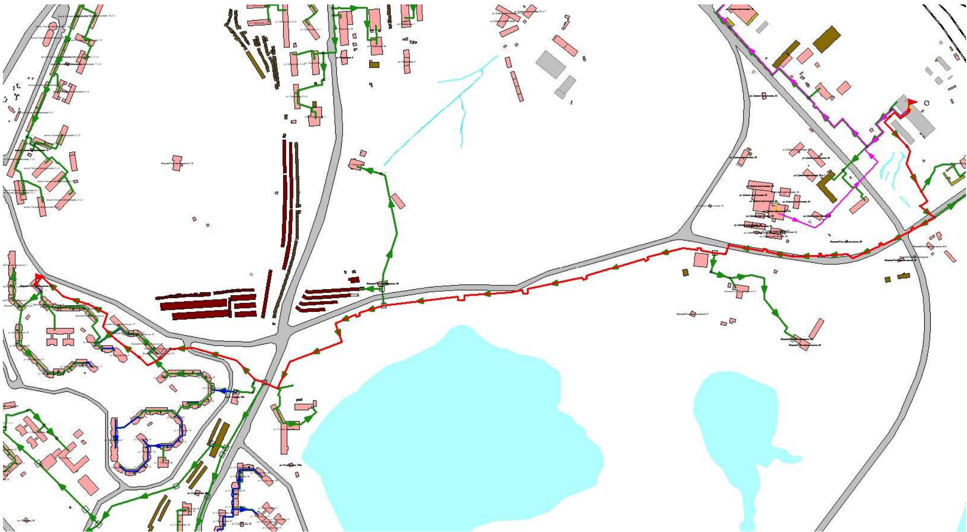
Рисунок 1.40. Путь построения пьезометрического графика Восточная котельная –ЦТП №5
