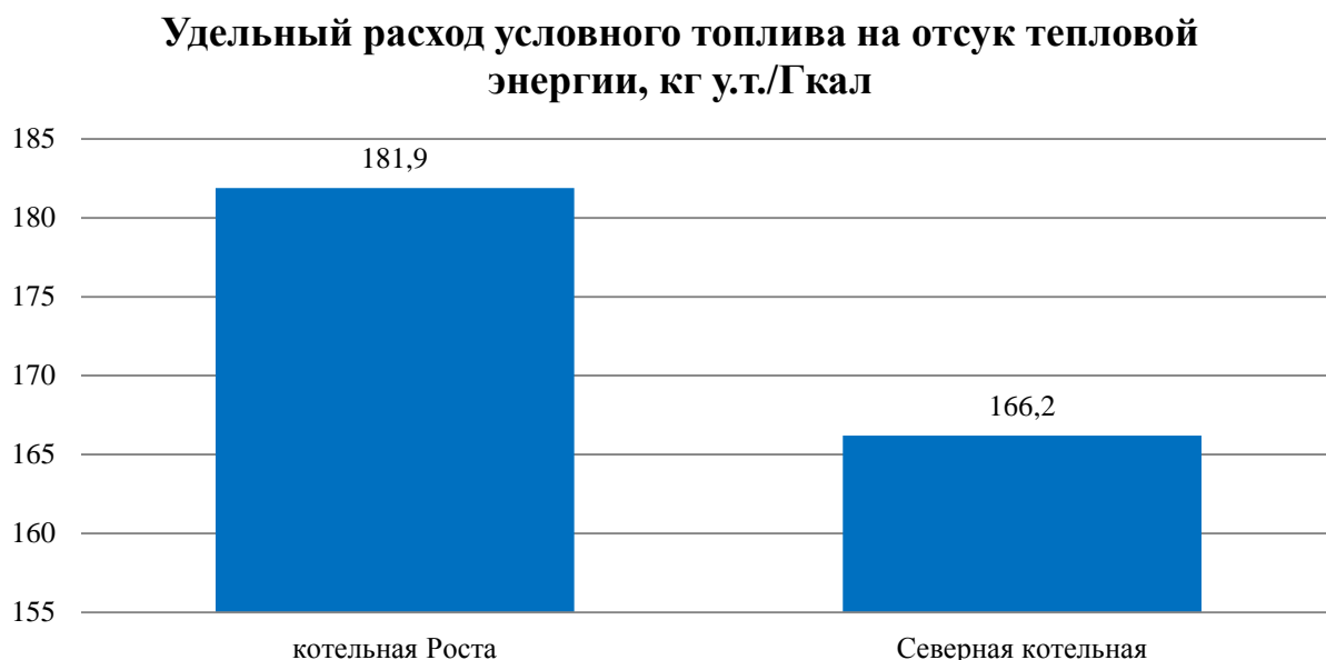
Рисунок 18 - Удельные расходы топлива на Северной котельной и котельной Роста
