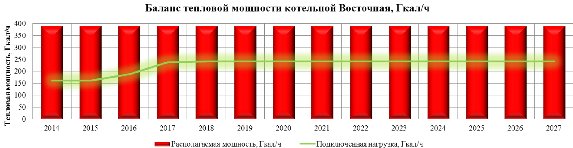
Рисунок 10 - Баланс тепловой мощности Восточной котельной на период разработки схемы теплоснабжения
