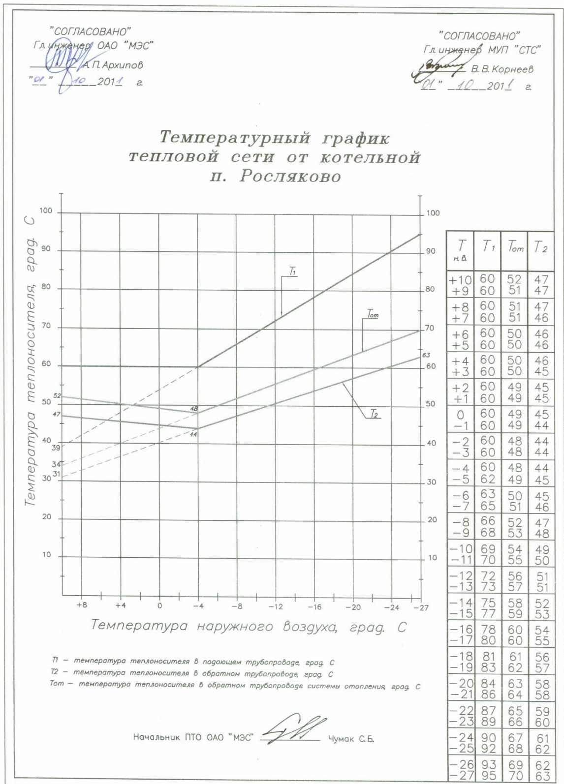
Рисунок 32 - Температурный график тепловой сети котельной ТЦ «Росляково-1»
