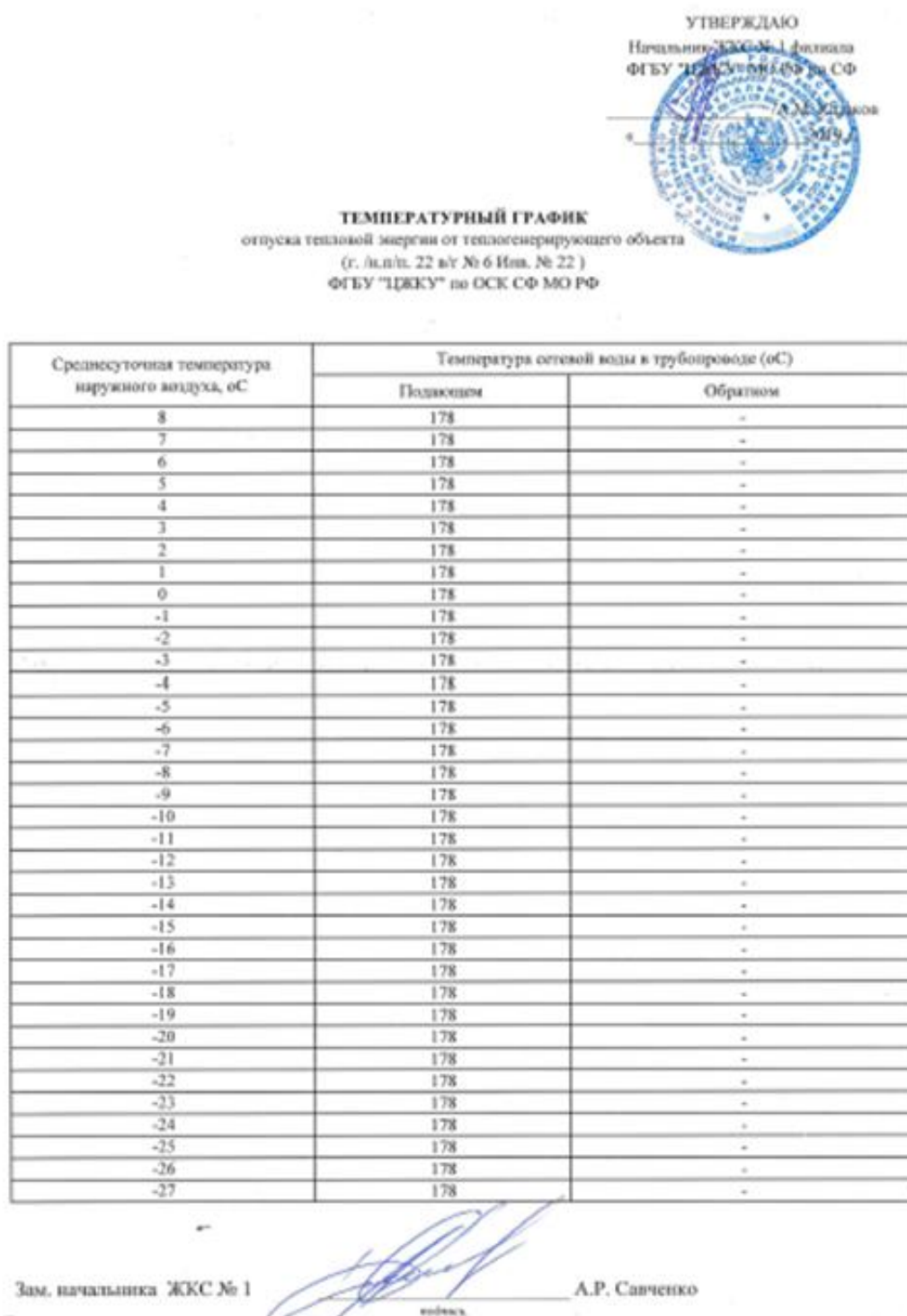
Рисунок 43 – Температурный график тепловой сети котельной №22
