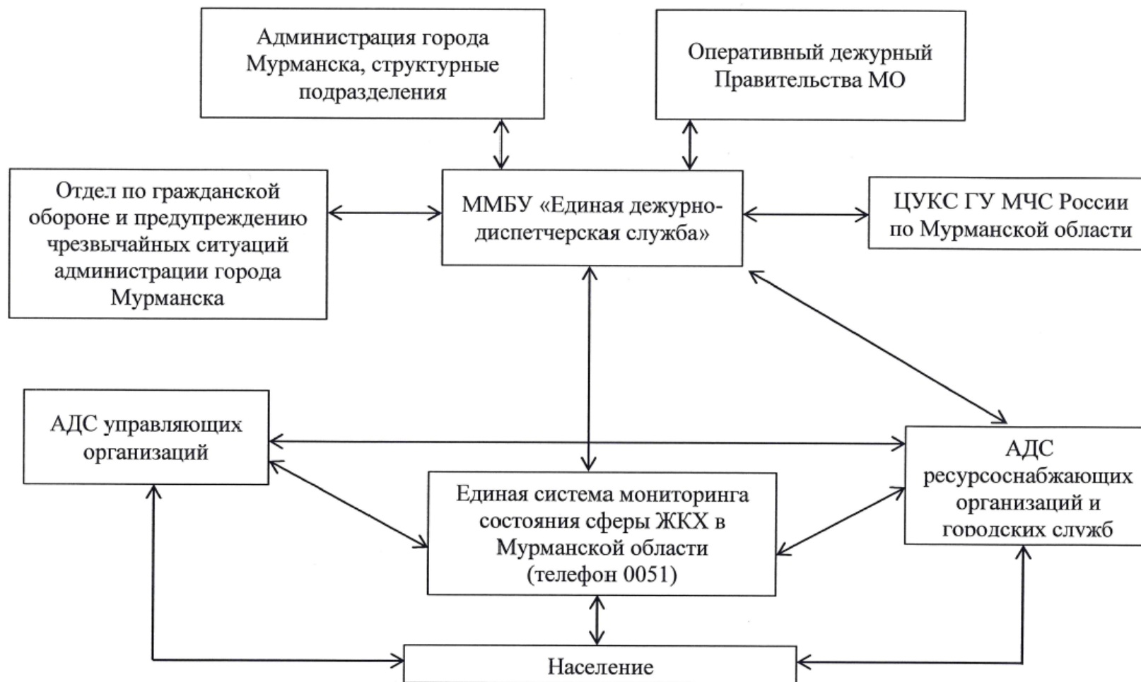
Рисунок 54. Схема взаимодействия Единой системы, ЕДДС, РСО, УО при проведении аварийно-восстановительных работ
