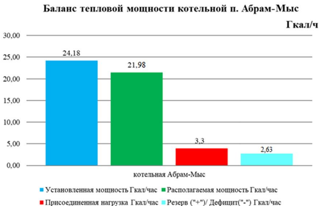
Рисунок 10. Баланс тепловой мощности котельной «Абрам-Мыс»
