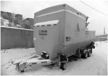
Снегоплавильная установка TRECAN
