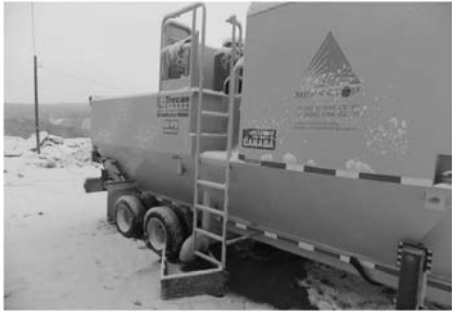
Снегоплавильная установка TRECAN
