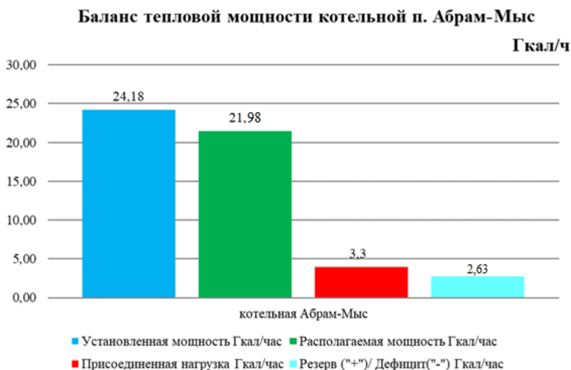
Рисунок 7.10 Баланс тепловой мощности котельной «Абрам-Мыс»
