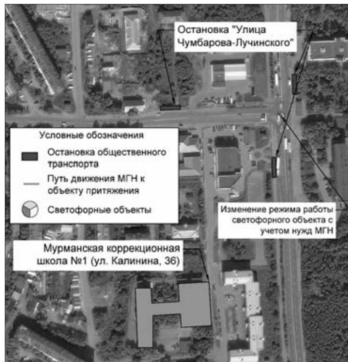
Рисунок 3.19.11 – Предлагаемая схема организации безопасных и комфортных подходов для МГН (остановка «Улица Чумбарова-Лучинского»)
