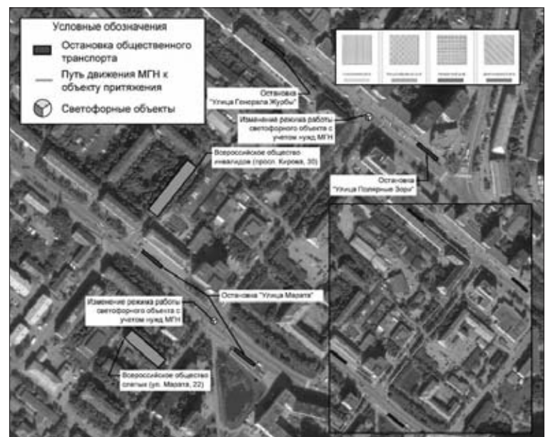
Рисунок 3.19.6 – Предлагаемая схема организации безопасных и комфортных подходов для МГН (остановка «Улица Генерала Журбы»)
