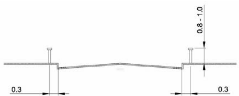
Рисунок 3.2.15 – Схема установки пешеходных ограждений на подходах к наземному пешеходному переходу. Поперечный профиль
