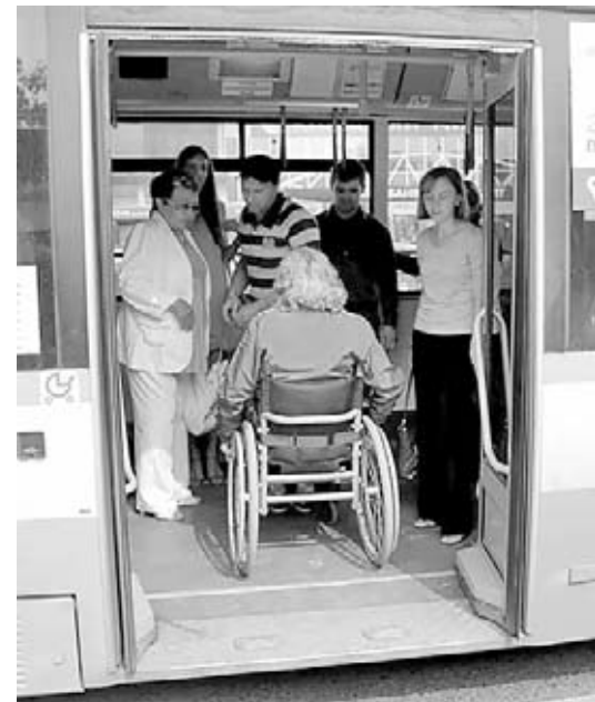
Рисунок 3.19.10 – Отсутствие площадки для представителя МГН в подвижном составе
