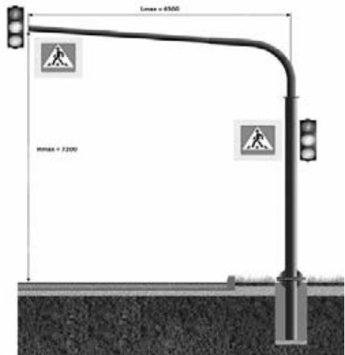
Рисунок 2.7.1 – Типовая схема размещения знаков и светофоров на Г-образной стойке
