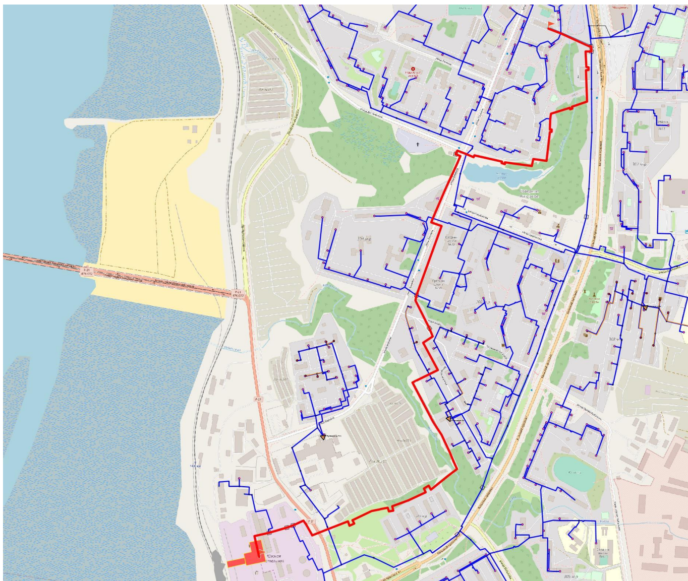
Рисунок 1.7. Путь построения пьезометрического графика Южная котельная – НС №4
