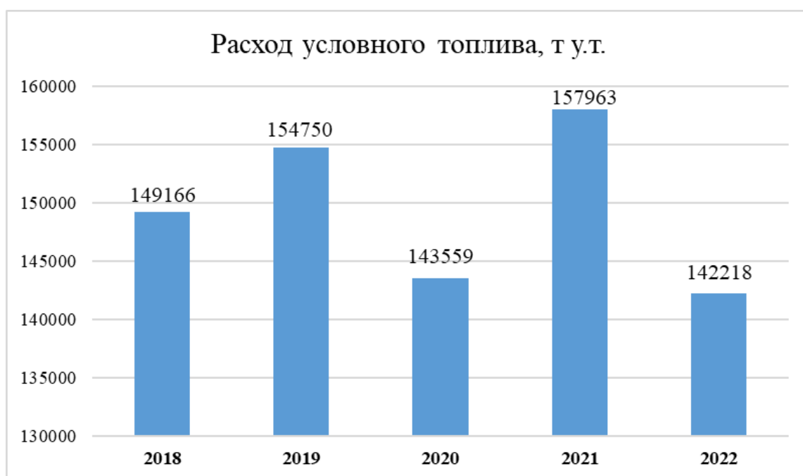
Рисунок 57 – Расход условного топлива на Южной котельной
