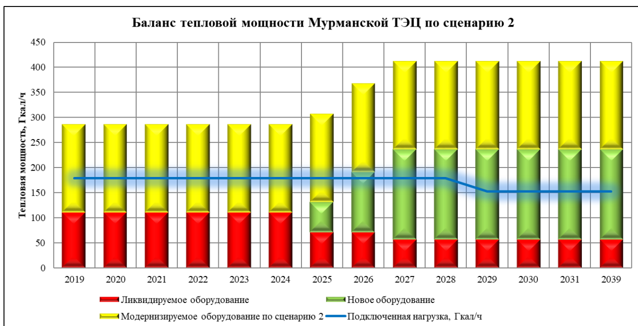
Рисунок 7.5 Баланс тепловой мощности Мурманской ТЭЦ на период разработки Схемы теплоснабжения по сценарию 2
