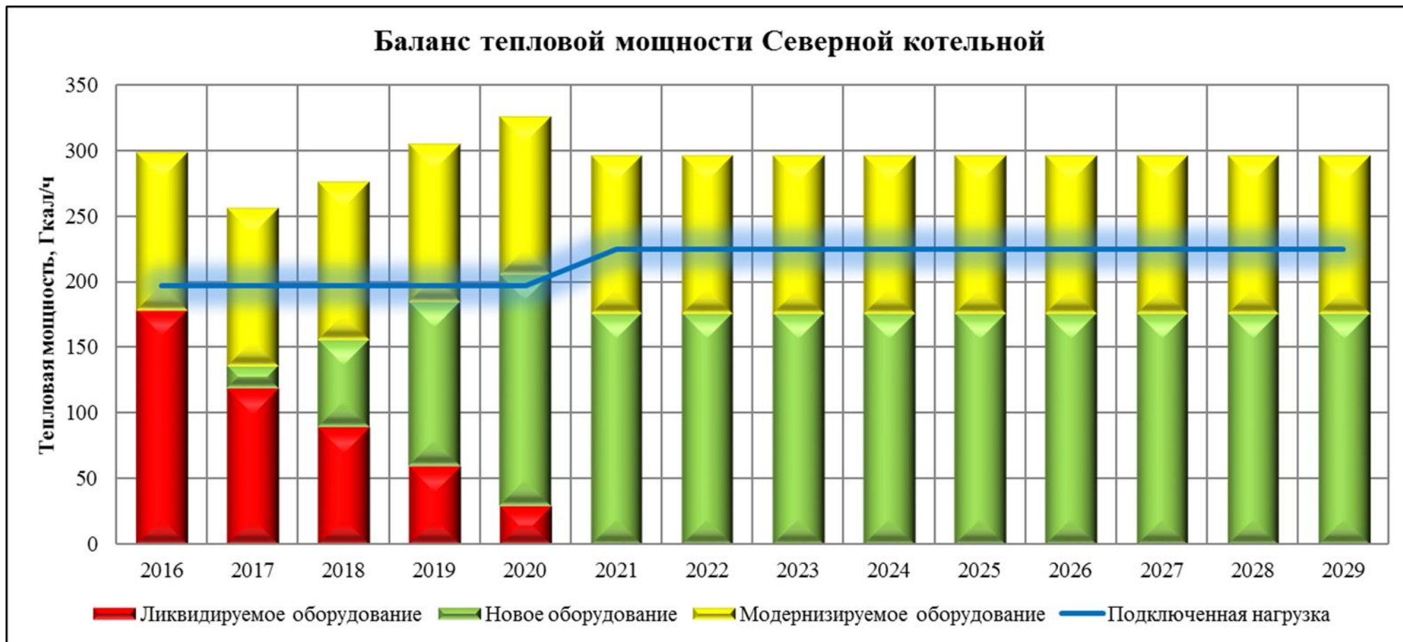
Рисунок 12.6. Баланс мощности и нагрузки котельной Северная по сценарию 1 и сценарию 2 (до 2028 года включительно)
