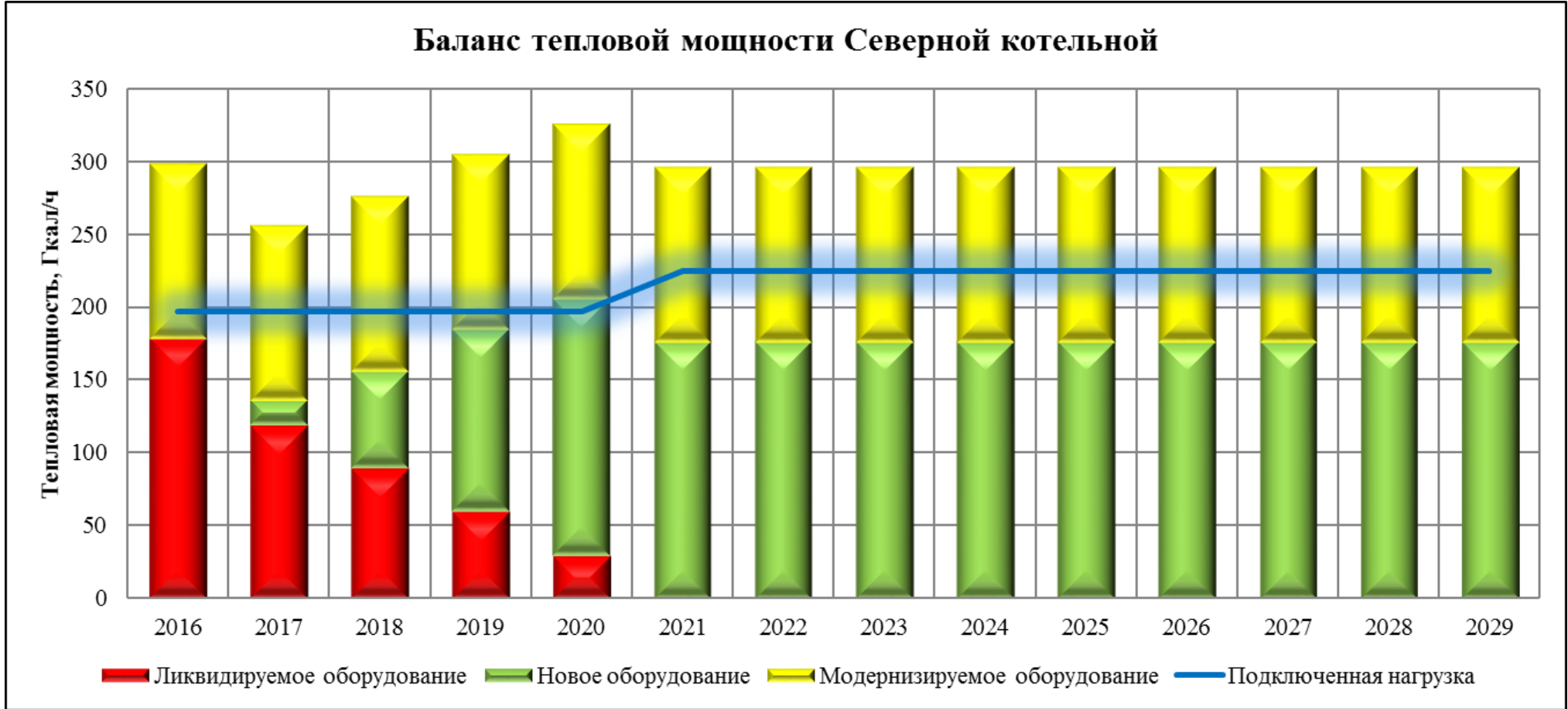
Рисунок 6.12 - Баланс мощности и нагрузки котельной Северная по сценарию 1 и сценарию 2 (до 2028 года включительно)
