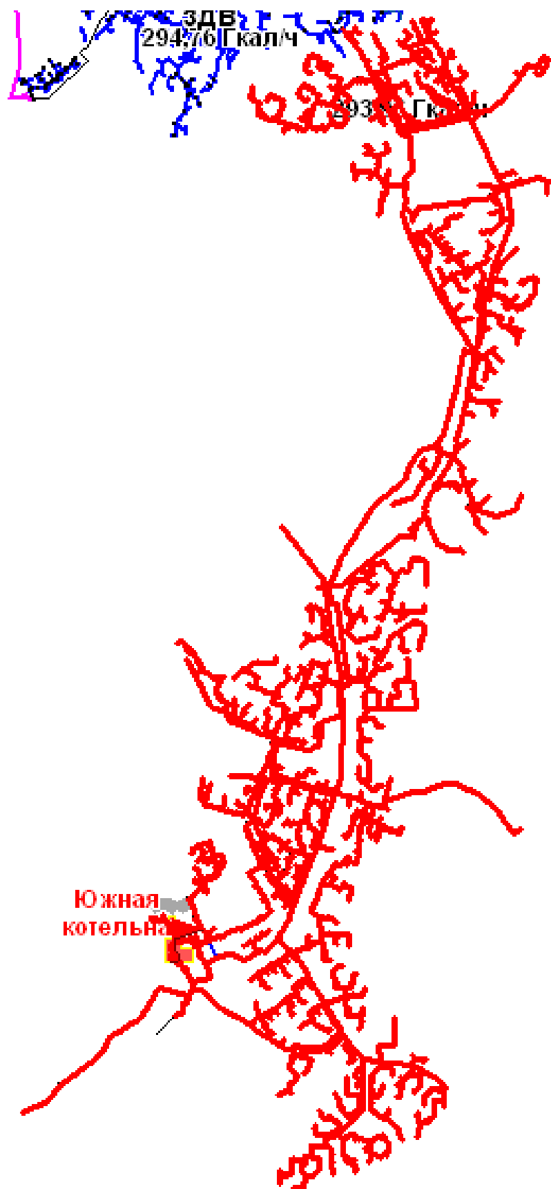
Рисунок 9.6 - Расчетная схема зоны теплоснабжения потребителей от существующей котельной
