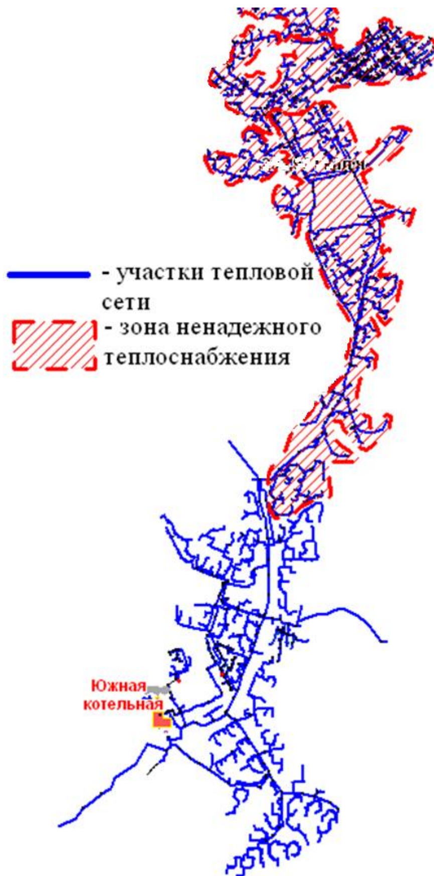
Рисунок 9.9 - Зона ненадежного теплоснабжения потребителей от Южной котельной
